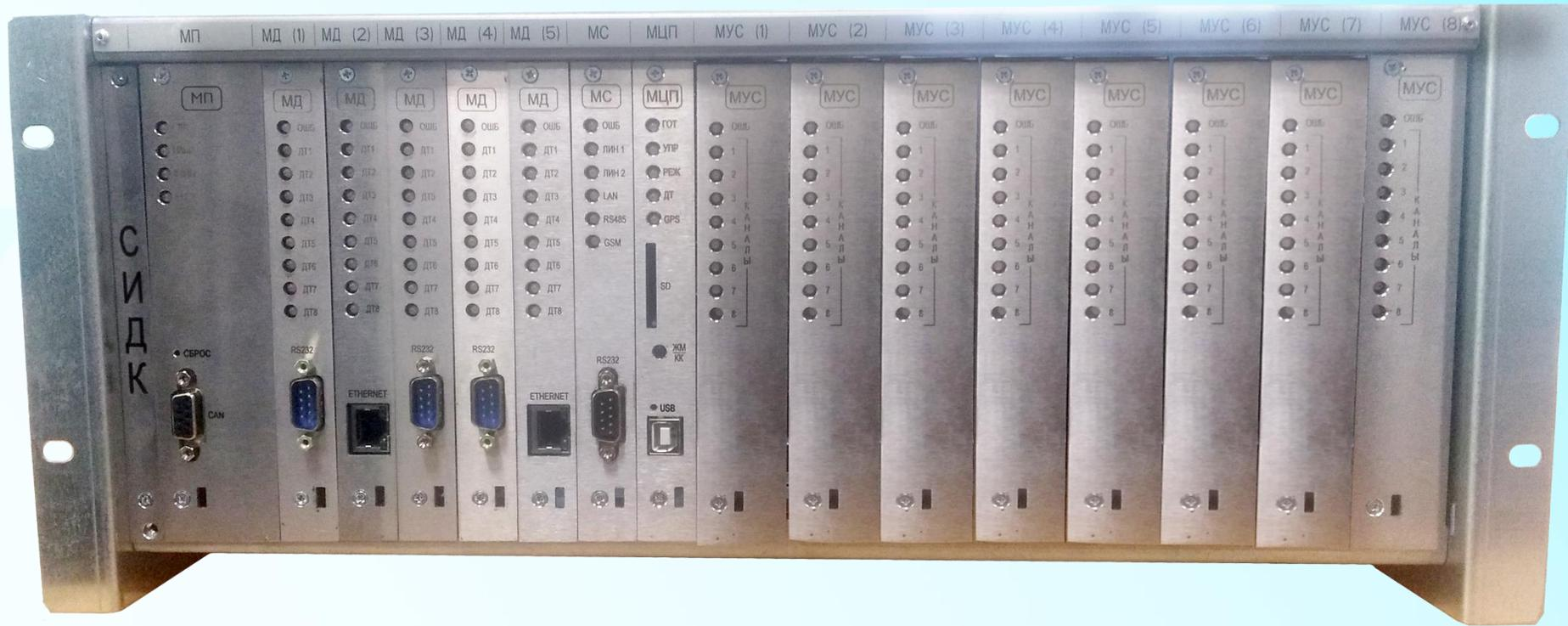
**СИДК** представляет собой современный, недорогой, постоянно развивающийся, надежный дорожный контроллер, построенный по модульному принципу.
